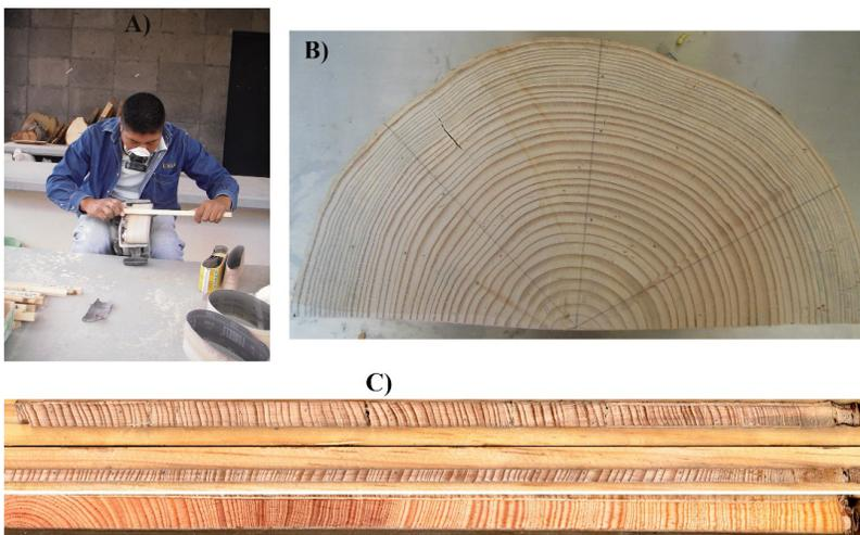
**Figura 6.** Lijado de muestras dendrocronológicas, A) lijado de núcleo con lijadora eléctrica, B) sección transversal de *P. pseudotsugus* lijada, C) núcleos de crecimiento de *P. hartwegii* lijados. Fuente: fotografías propias
