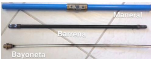
**Figura 4.** Piezas de taladro tipo Pressler (10 milímetros de diámetro). Fuente: fotografía propia
