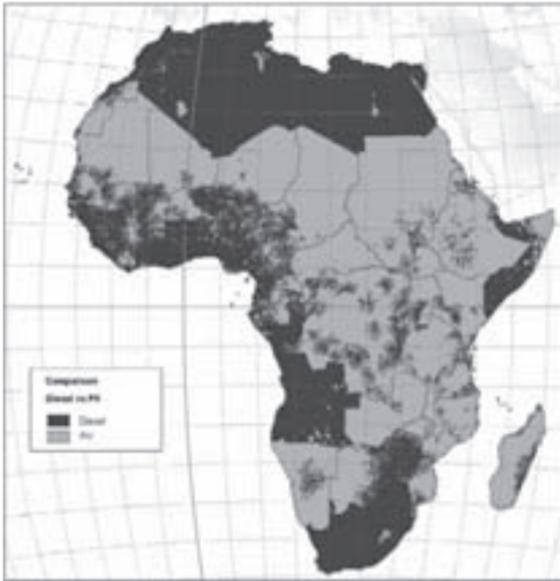
FIGURA 1. OPCIONES DE SISTEMAS AISLADOS: COMPARACIÓN ECONÓMICA DE GASÓLEO FRENTE A FOTOVOLTAICA.
