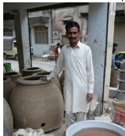
Además del tandoor incrustable en los suelos de las cocinas, existe el modelo de tamaño intermedio y portátil. Se trata de una estufa compuesta por un horno como el anterior, pero más pequeño, que meten dentro de un barril de combustible y rellenan el hueco entre los dos de tierra, con lo que consiguen gran inercia térmica. La parte superior la cubren con un aro de hormigón y la sellan con adobe.
