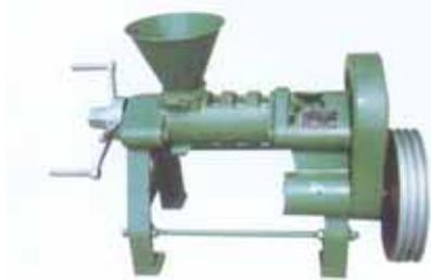
*Propulsión:* La prensa se compra con un motor eléctrico trifásico de 3 Kw de potencia. Dicho motor se podría conectar a la red de energía o alimentar con un generador. La otra opción sería desmontar el motor eléctrico y conectar las correas a un motor de explosión. En cualquiera de los dos últimos casos se estima que el gasto de combustible será aproximadamente de 30 litros de combustible por 8 horas de trabajo.
