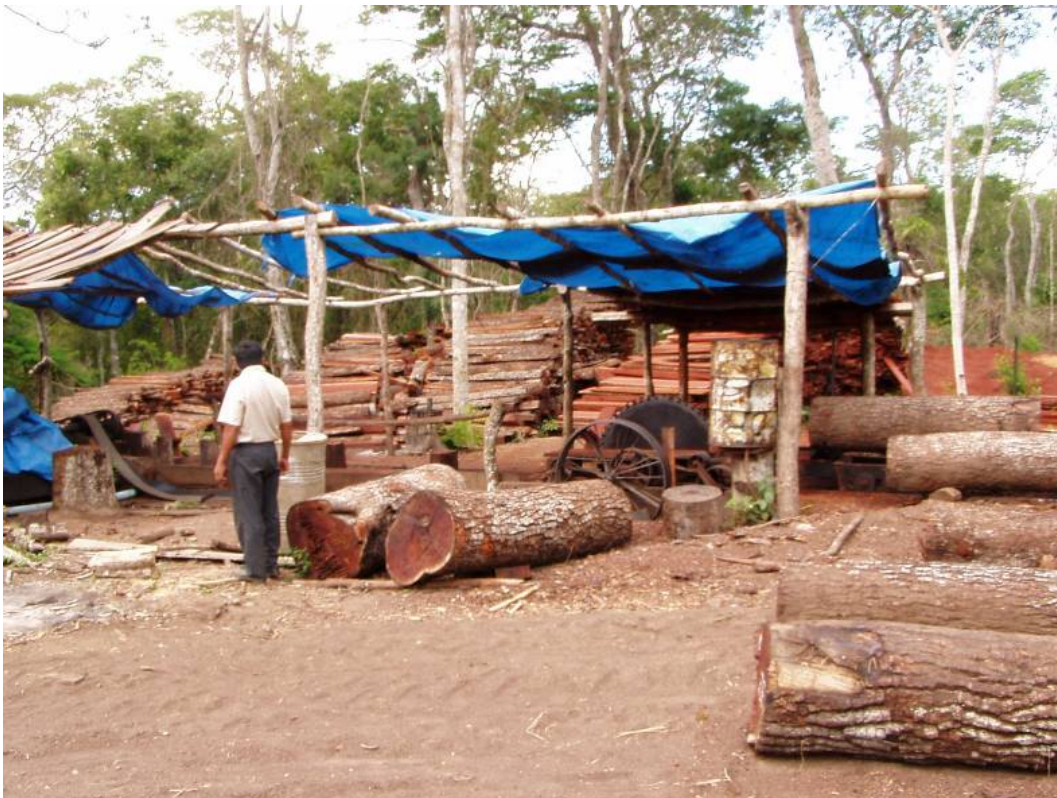
FOTO 5.3. Aserradero circular instalado en AFOMASAN para traviesas de ferrocarril
