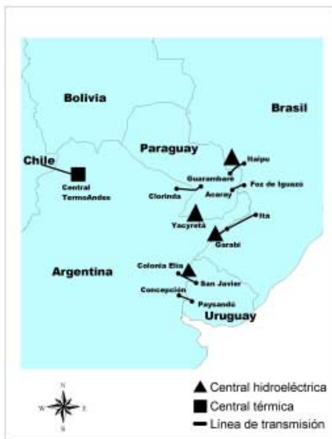
Gráfico III.3 CONO SUR: INTERCONEXIONES ELÉCTRICAS
